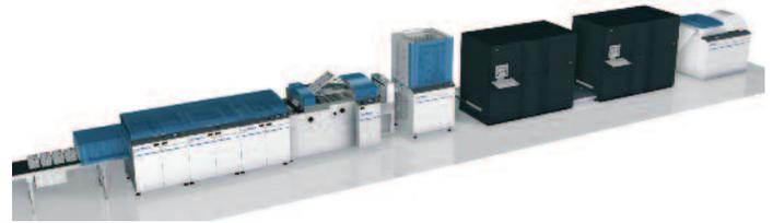
Für die Produktion von Büchern sowie die Direct-Mails kommen neben der Digitaldruckmaschine Abroller von Hunkeler sowie Schneidemodule und Transportsysteme zum Einsatz.
