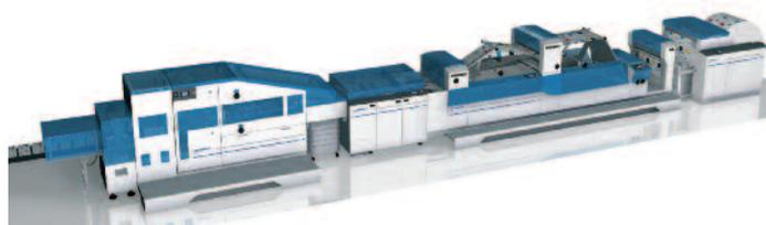
die Weiterverarbeitung ist dank einer integrierten Buchblockkleimung gesichert. Eine Vollständigkeitskontrolle der Buchblocks erfolgt über Datamatrix mit visueller Überwachung der Qualität und des Produktionsfortschritts am Monitor. Die Buchblockentnahme und Ablage auf die Transportwagen erledigt ein Roboter. Das Finishing der Bücher erfolgt auf einem Klebebinder von Horizon im Nearline-Verfahren.
